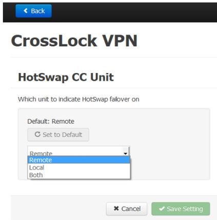
Luego selecciona “HotSwap CC Indicator” y selecciona que contacto seco vas a activar. Esto va a cambiar cualquier configuración que tenias antes en los contactos secos.
