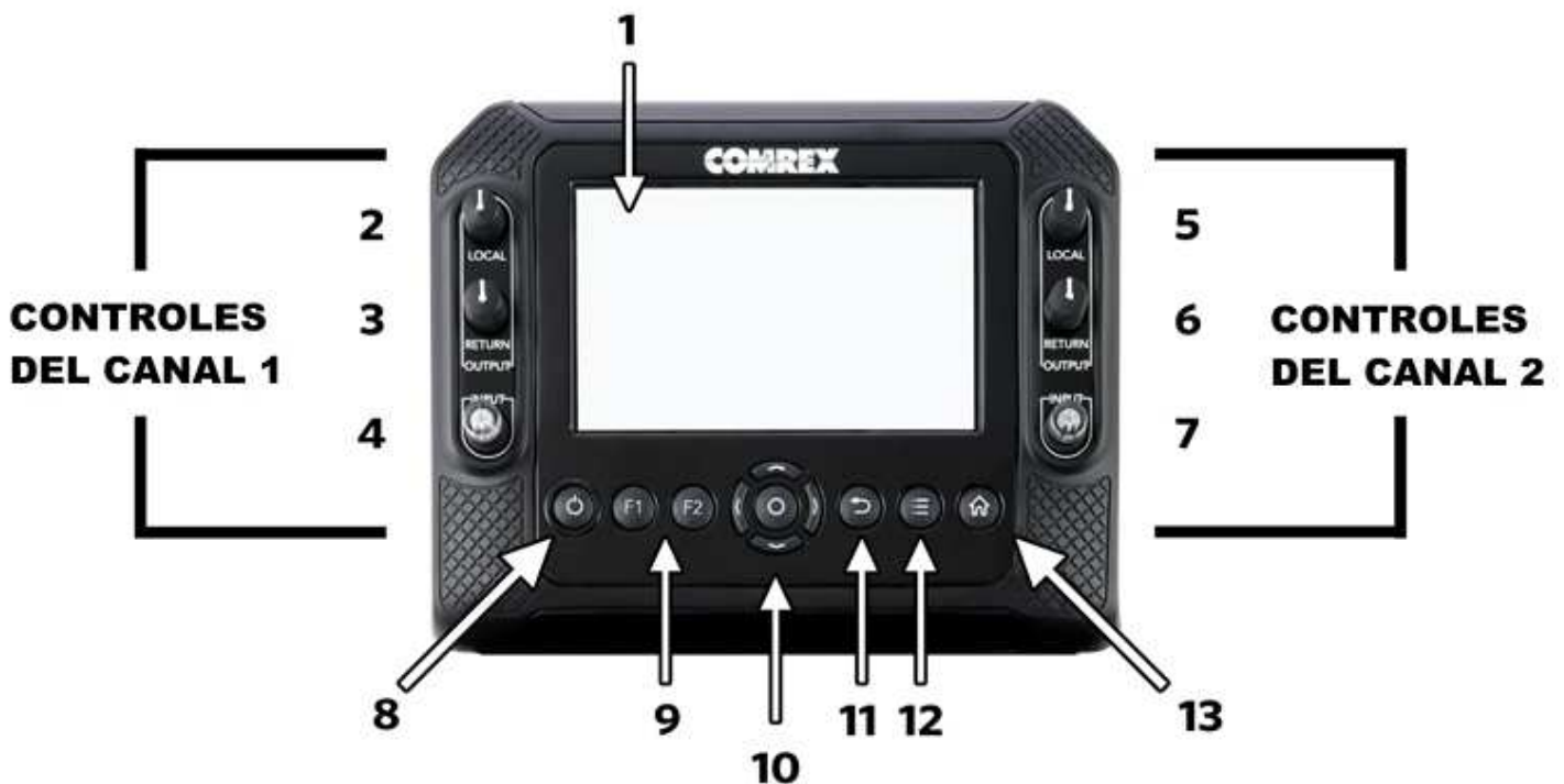
Figura 1 DIAGRAMA Y DESCRIPCIÓN DEL PANEL FRONTAL
