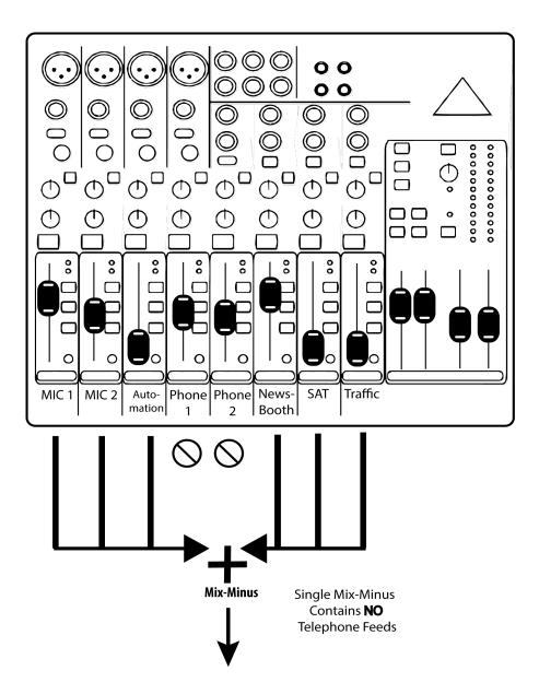
El uso de Opal complica un poco las cosas porque requiere un par de alimentaciones Mix-minus si ambos canales se van a utilizar en el mismo estudio. Esto se debe a que Opal no conecta a los dos llamantes que recibe, y cada llamador necesita un mix-minus personalizado para escuchar al otro, junto con el audio generado por el estudio. Esto se muestra en el siguiente diagrama.
