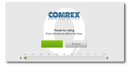
El invitado al presionar "**Connect**" se creará un enlace de audio de alta calidad a uno de los dos canales del Opal. La conexión finalizará cuando la persona que llama aprieta el botón de "**Disconnect**".
